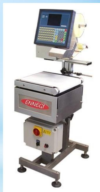
**Il tutto sarà montato su telaio inox con piedi regolabili (dimensioni da definire) e dotato di quadretto elettrico a tenuta stagna.**
