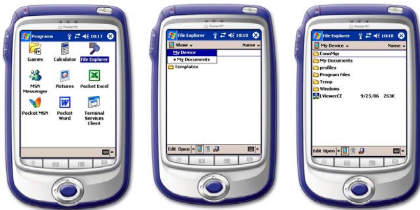
Figura 1: steps per avviare l'applicazione LviewerCE. Da Programmi, selezionare Esplora File (File Explorer), posizionarsi su Dispositivo (My Device) ed eseguire LviewerCE.
