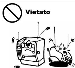
Non inserire o lasciar cadere metallo, materiali infiammabili od altri corpi estranei nella macchina attraverso le aperture di ventilazione, poiché ciò può causare **incendi** o **shock elettrici**.
