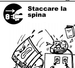
Se le macchine sono fatte cadere o la loro carrozzeria viene danneggiata, spegnere gli apparecchi e staccare la spina di alimentazione dalla presa, quindi contattare il rappresentante autorizzato TOSHIBA TEC. Protrarre l'uso della macchina in tali condizioni può causare **incendi** o **shock elettrici**.
