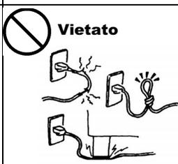
Non scalfire, danneggiare o modificare i cavi di alimentazione. Inoltre, non posizionare i cavi sotto oggetti pesanti, non tenderli o piegarli eccessivamente, poiché ciò può causare **incendi** o **shock elettrici**.
