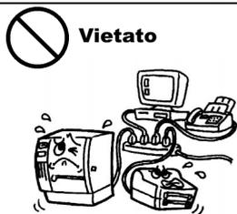
Se le macchine condividono la stessa presa con altri apparecchi elettrici che consumano molto, il voltaggio subirà ampie oscillazioni ogni qualvolta che questi dispositivi operano. Assicurarsi di utilizzare una presa esclusiva per le macchine, onde evitare **malfunzionamenti**.
