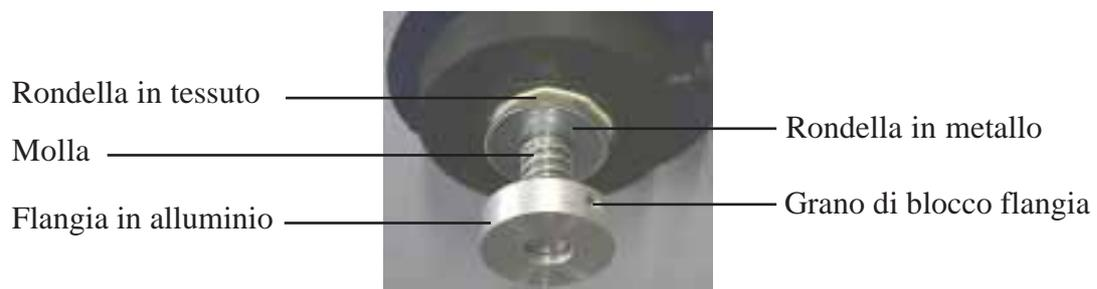
Figura 7 : Particolare della frizione dello svolgitore.
