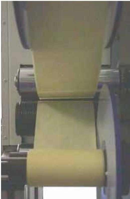
Figura 5 : Particolare dell'allineamento del nastro di etichette tra rullo svolgitore e rullo avvolgitore.
