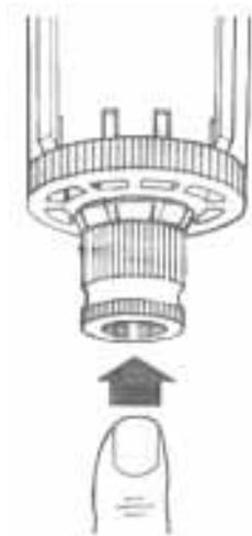
Figura 9 : Particolare del regolatore di pressione per lo scarico della condensa.
