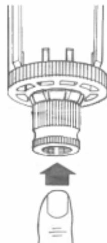
Figura 14 : Particolare del regolatore di pressione per lo scarico della condensa.
